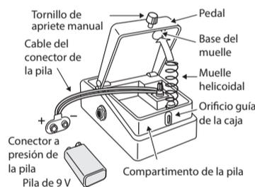
1. Mantenga pisado el pedal y afloje el tornillo de apriete manual; a continuación, abra el pedal hacia arriba.
