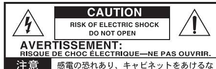
L'éclair dans le triangle est un symbole destiné à attirer l'attention de l'utilisateur sur la présence de parties non isolées et de "tension dangereuse" à l'intérieur de l'appareil, qui posent des risques d'électrocution pour l'utilisateur.
