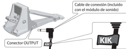
Si utiliza el modelo TD-30, vaya a la pantalla "TRIGGER SENSITIVITY" y ajuste el parámetro "KICK" > "Trig Type" al valor "KD-120". Si utiliza el modelo TD-15/TD-11, vaya a la pantalla "PAD SETTINGS" y ajuste el tipo de pad "KIK" al valor "KD-120".
