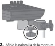
2. Afloje la palomilla de la montura del soporte e inserte la montura del módulo de sonido.
