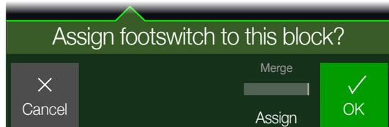
Si deseas sustituir otros bloques que es posible que ya estén asignados al conmutador de pedal, gira el mando 4 (**Assign**) para seleccionar “**Replace**”. De lo contrario, déjalo ajustado a “Merge”, que permite que varios bloques se asignen al mismo conmutador.
