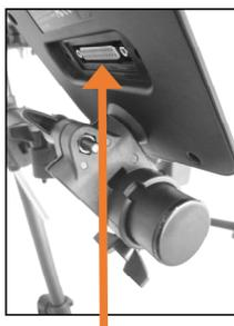
Conecte aquí el multicable (usando los dos tornillos para fijarlo) y luego conecte los extremos de 1/4 pulg. de los cables a sus pads respectivos.
